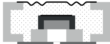
La imagen muestra un sensor de presión piezorresistivo con diafragma separador, relleno de aceite y capa activa.
